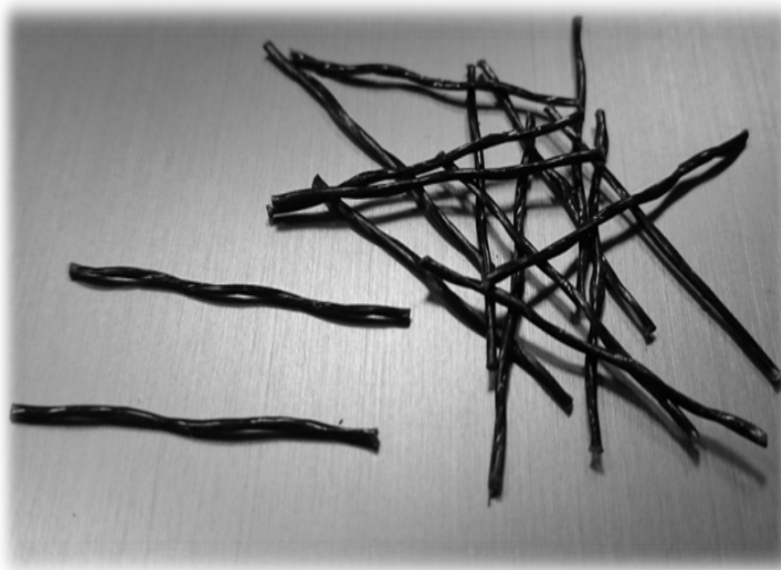
Рис. 7 Базальтовая фибра производства ООО «Рекстром-М»
