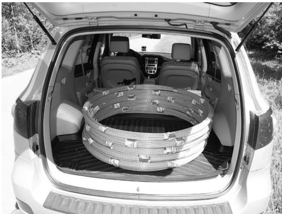
Рис. 6 В багажнике автомобиля лежит 500 метров арматуры АКП-СП-6 диаметром 6 мм — 5 бухт по 100 метров общим весом 18 кг
